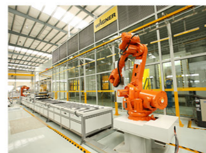
自动覆膜 & 机器人装箱线 Automatic laminating & robot packaging line
