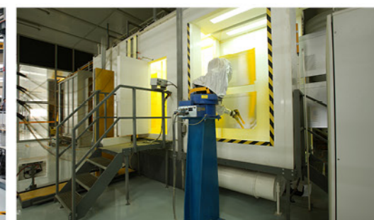
喷粉机器人 Spray painting robot
