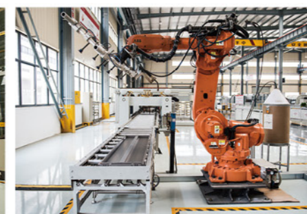
瑞士 ABB 焊接机器人 Swiss ABB welding robot
